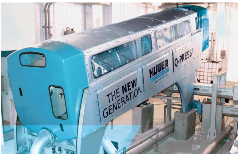
Figur 4. Skruerpresse type Q-press fra Hydropress Huber AB avd. Norge.
