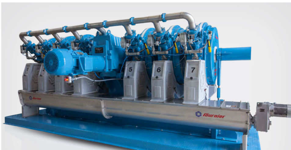
Figur 3. Skruerpresse type Fournier fra leverandør Lange Lyche AS i Norge. Bildet viser en installasjon med 7 kanaler.
